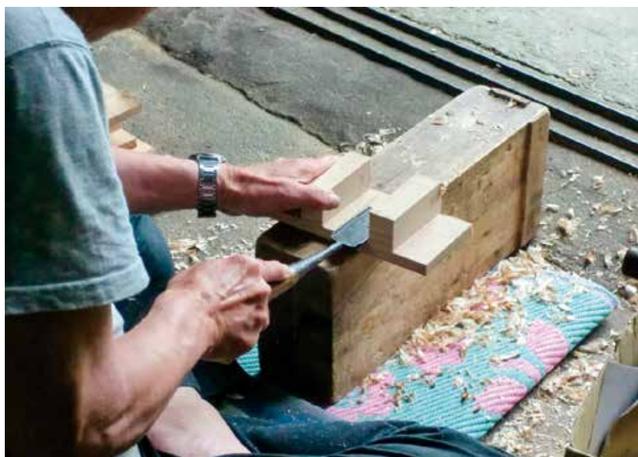
図4 専用の刃物を使って桐下駄を製造している様子
